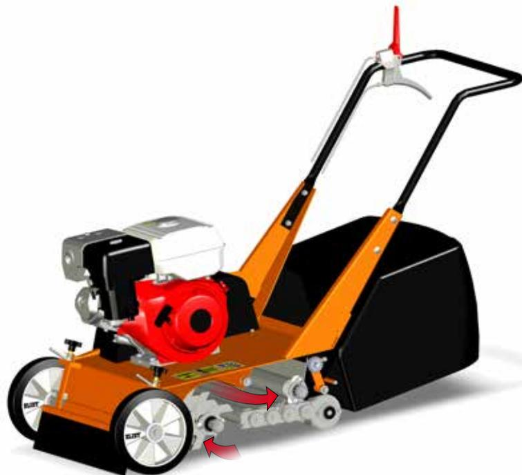
**1.** Le grand avantage de l'E600 COMPACTOR est sa collecte forcée. Si l'on veut scarifier un gazon de manière traditionnelle, l'opération requiert au moins deux traitements: l'arrachage puis l'évacuation de la mousse. Avec l'ELIET E600 COMPACTOR, ces 2 étapes s'effectuent en un seul mouvement, **réduisant ainsi le temps de travail global de 50%!**
